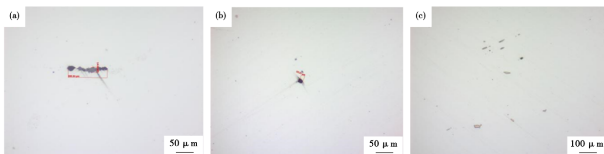
图3 H13模具钢不同夹杂物类型:(a)B类夹杂,(b)D类夹杂,(c)TiN夹杂
